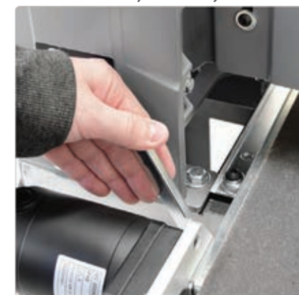
Dźwignia do podnoszenia stołu podczas szlifowania szerokich elementów
