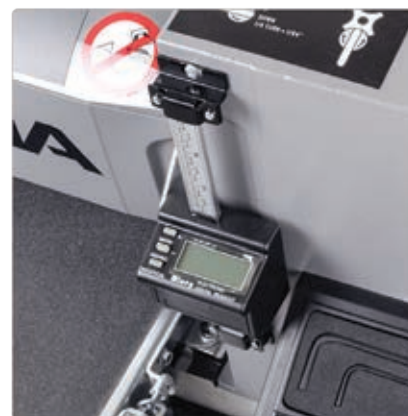
Cyfrowy wskaźnik grubości obrabianego elementu
