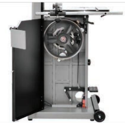
Hamulec tarczowy do szybkiego zatrzymania
