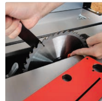
Dźwignia do szybkiej wymiany tarczy
