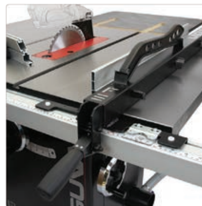
Stół żeliwny z przesuwaną przykładnicą
