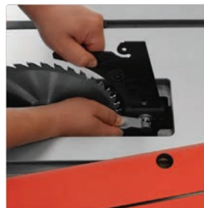
Szybkie mocowanie klina rozszczepiającego
